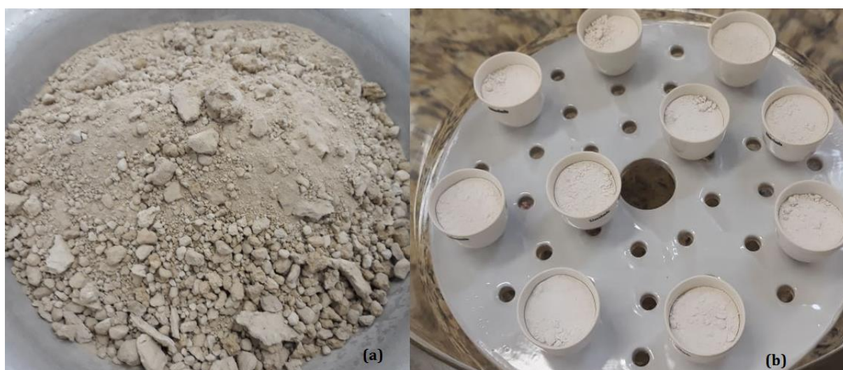
Figura 2. Material após secagem em estufa (a) e após calcinação (b).
