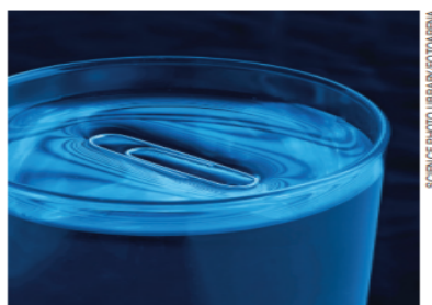
Figura 23 Um pequeno clipe de aço, se colocado delicadamente sobre a água, não perfura a superfície e não afunda. Esse fenômeno decorre da elevada tensão superficial desse líquido.
