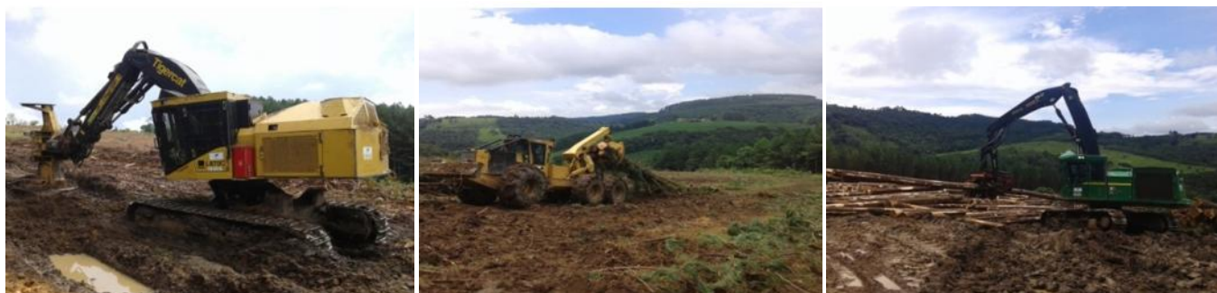
FIGURA 1 - Feller buncher (esquerda), Skidder (centro) e processador harvester (direita) utilizados no sistema de colheita árvores inteiras ( full tree ). Fonte: Acervo próprio (2018).
