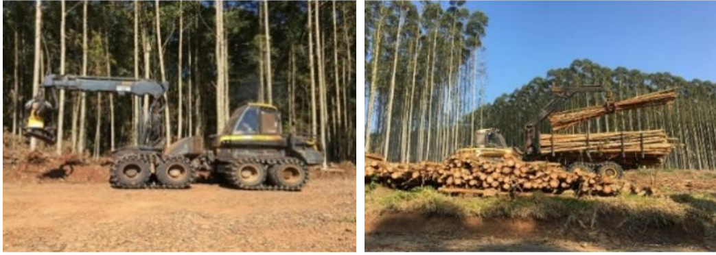
FIGURA 2 - Harvester (esquerda) e forwarder (direita) utilizados no sistema de colheita de toras curtas ( cuttolength ). Fonte: Acervo próprio (2018).
