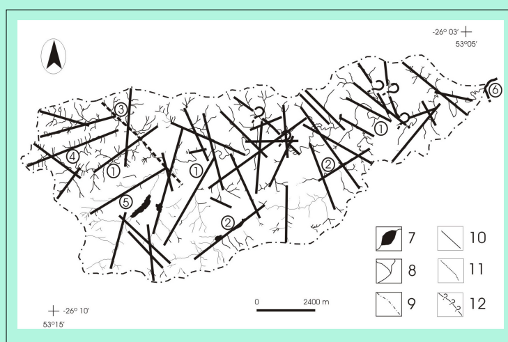
FIGURA 2 – Mapa de Lineamentos da Bacia do Rio Quatorze. (1) Quatorze. (2) Lajeado Grande. (3) Arroio Casa Blanca. (4) Córrego Serraria. (5) Córrego dos Mouros. (6) Marrecas. (7) Açude. (8) Drenagem. (9) Divisor d'água. (10) Lineamentos. (11) Falha. (12) Falha provável.
