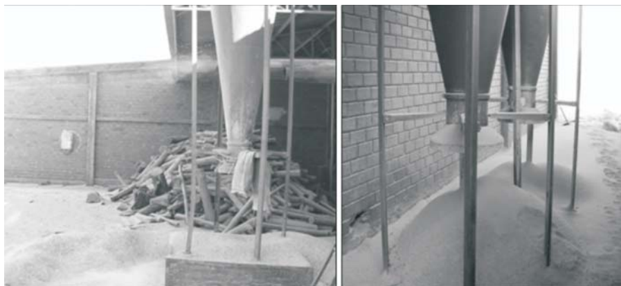
Figura 2 Exposição ambiente de impurezas e particulados de produto provenientes do sistema de pré-limpeza e limpeza de produtos agrícolas.
